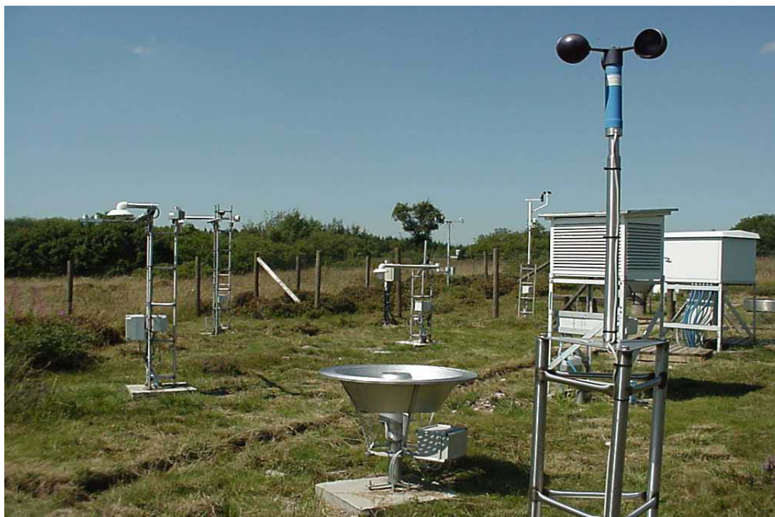
La station de mesures automatiques de l'IRM à Mont-Rigi : à l'avant plan, le pluviomètre (pour la mesure des précipitations) et un anémomètre (pour la vitesse du vent à 2 m). Plus loin, l'abri pour la température et l'humidité ainsi que d'autres instruments pour les mesures de rayonnement, de température du sol et d'épaisseur de neige (photo : IRM).
