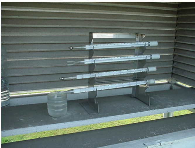
Deze thermometers meten de minimum- en maximumtemperaturen.
