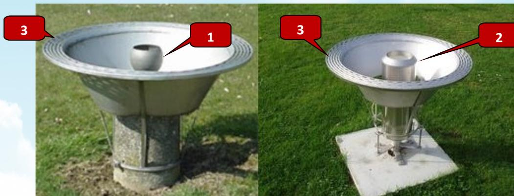
*A gauche : un pluviomètre manuel (1). A droite : un pluviomètre automatique (2). Tous deux sont équipés d'un cône de Nipher (3), dont la fonction est de diminuer l'influence du vent sur les mesures.*
