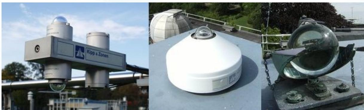
*A gauche et au milieu : 2 modèles de pyranomètre. A droite : un héliographe.*
